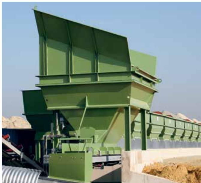
Doseur d'ajout de recyclés RA, avec grille vibrante inclinée.
