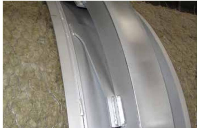
Isolation haute performance du tambour sécheur avec revêtement aluminium de protection. Pour une meilleure précision du tambour sécheur, la couronne de roulement est montée sur des lames à ressort afin de compenser la dilatation thermique.
