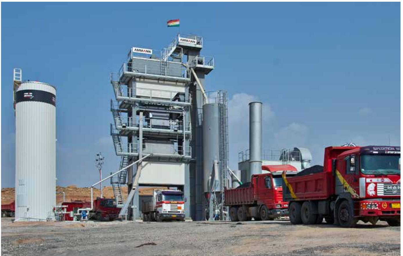
L'Unibatch offre de nombreuses possibilités de production avec différents additifs tel que du recyclé à froid ou à chaud, de l'AmmannFoam via un générateur de mousse de bitume, des fibres, des pigments, des additifs liquides, des zeolite, etc.
