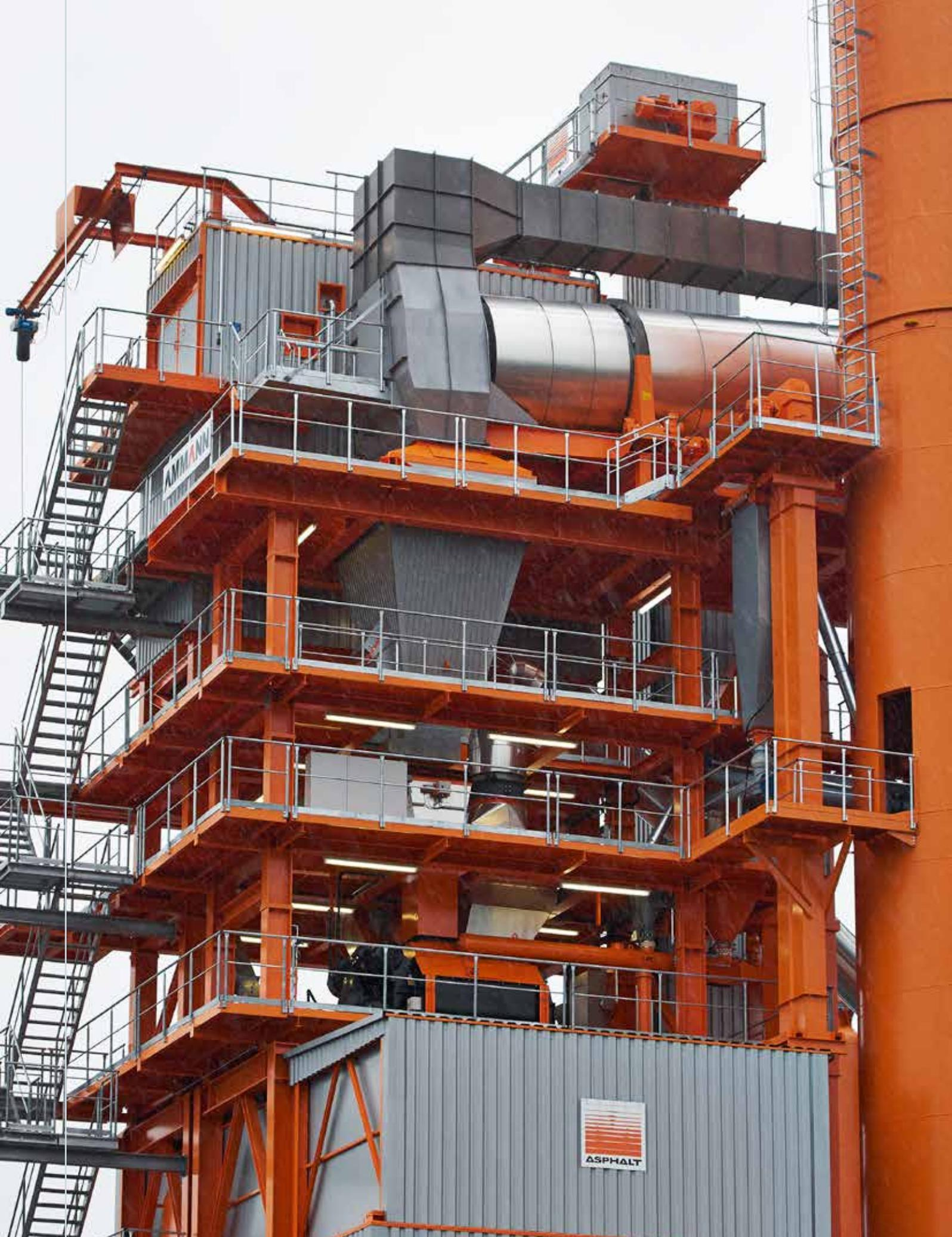
L'Universal HRT offre dans le système de recyclage un flux optimal des minéraux, combiné avec une usure réduite au minimum.
