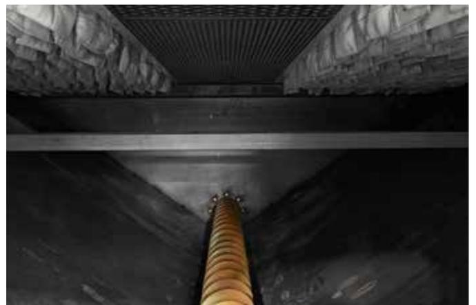
Vis d'extraction du filtre facilement accessible et manches de filtre Ammann résistantes à la chaleur.
