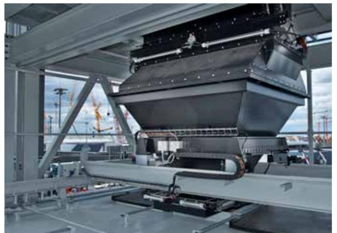
Benne navette entièrement carénée pour réduire les émissions de poussière et de fumée.
