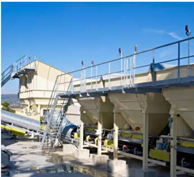
Option : Prédoseurs équipés de témoins lumineux et sondes de niveau laser.
