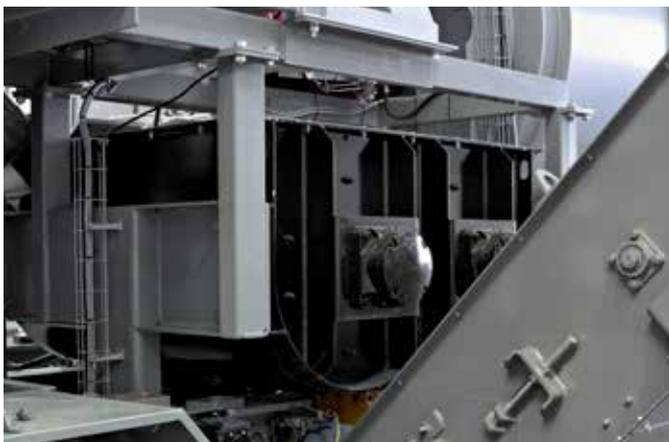
Malaxeur à mélange forcé à arbre double Ammann avec temps de malaxage réglable.
