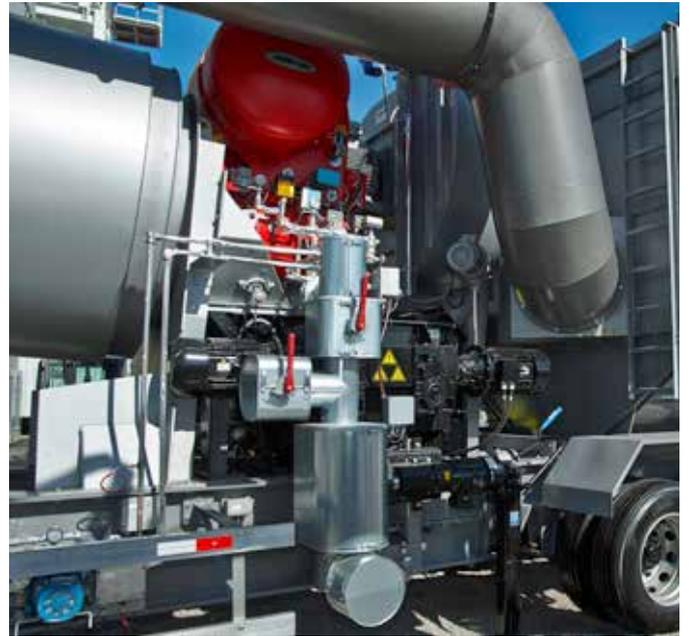
Tambour à flux contre-courant Ammann avec brûleur à efficacité optimisée et gaine des gaz bruts intégrée, ainsi que malaxeur Amix avec temps de malaxage réglable et alimentation en bitume isolée et chauffée.
