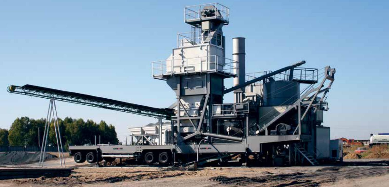
Dans sa version de base la BlackMove I est montée sur cinq semi-remorques et tractée par un véhicules tracteur standard. Les dimensions sont compactes et la charge répartie par essieu est faible.
