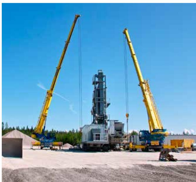
Grande facilité de montage sur place : les élévateurs (élévateur à filler et élévateur à chaud), la pompe à bitume fixée sur le pied d'élévateur à chaud, ainsi que le train de roulement constituent une seule unité très fonctionnelle.
