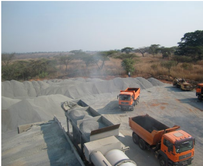
La Prime 140 est équipé en base de trois doseurs agrégats vierges.
