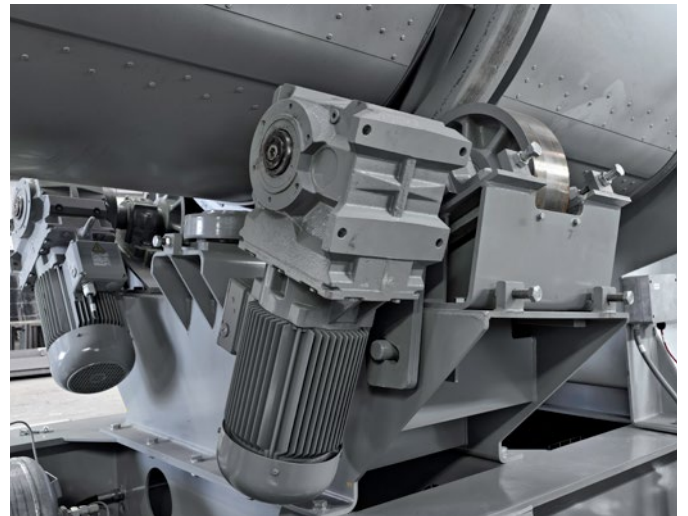
Les quatre entraînements du tambour sécheur sont facilement accessibles et sont réglables individuellement.
