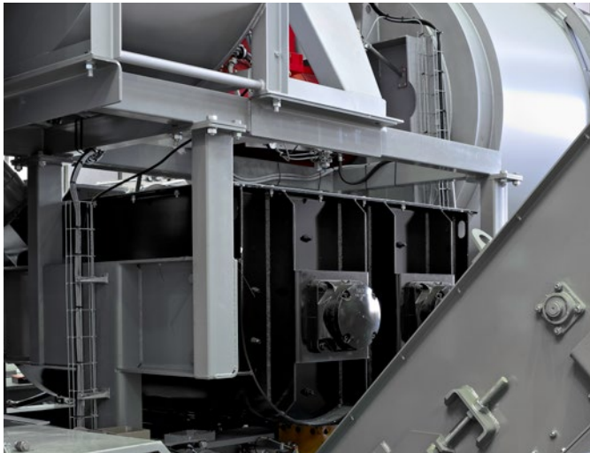
Malaxeur à mélange forcé à arbre double Ammann avec temps de malaxage réglable.
