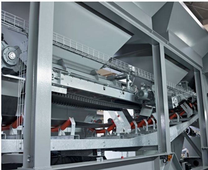
Prédosage : pesage individuel des minéraux grâce à un tapis doseur avec table de pesée.
