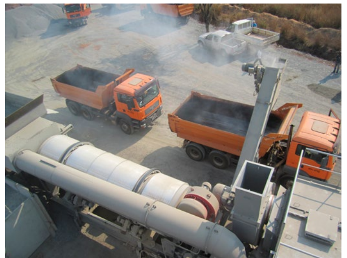
Le chargement d'enrobés dans les camions est fait via un convoyeur à raclette et une trémie anti ségrégation.
