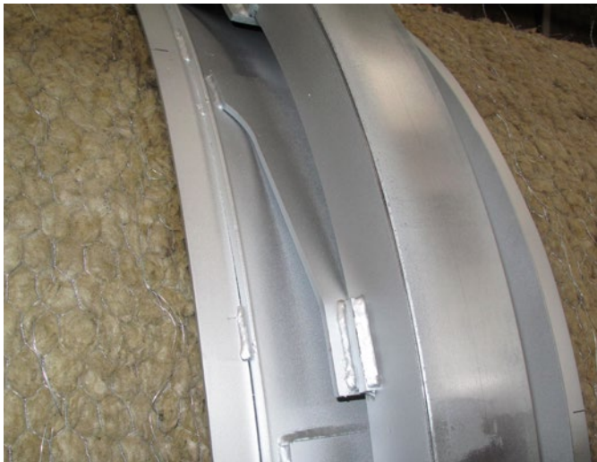
Isolation haute performance du tambour sécheur avec revêtement aluminium de protection. Pour une meilleure précision du tambour sécheur, la couronne de roulement est montée sur des lames à ressort afin de compenser la dilatation thermique.
