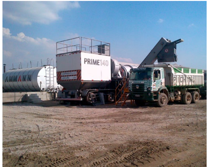
Option: Prime 140 avec une cuve compartimenté fuel/bitume.
