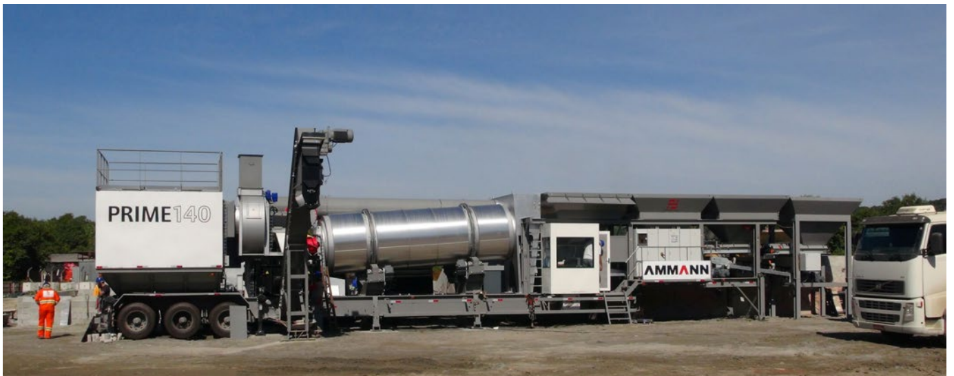
La Prime 140 installé en phase de production: sa longueur totale est de 22,7 mètres.
