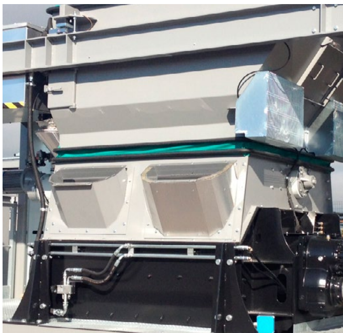
Malaxeur déjà conçu pour l'ajout intégré d'enrobés de recyclage à chaud ou à froid.
